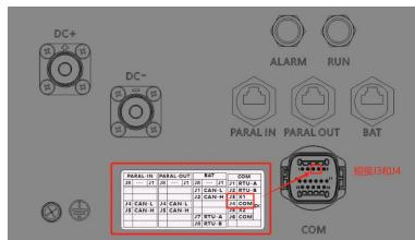
默认常开无源触点接入，短接时触发 EPO。若使用常闭触点，软件需要配置 328 地址之外，
