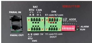
默认常开无源触点接入，短接时触发 EPO。若使用常闭触点，软件需要配置 328 地址之外，仍需配置 319 地址。
